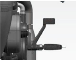
**Pedal de freno trasero:** La palanca del freno trasero está situada en el lado derecho junto al motor. Cuando necesite frenar la rueda trasera, pise la palanca de freno.
