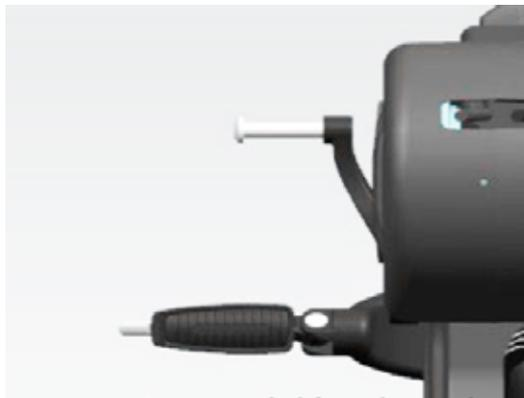
**Palanca de cambio:** El vehículo está equipado con una transmisión de seis velocidades, y cuando usted actúa sobre la palanca de cambios hacia arriba y hacia abajo para cambiar de marcha, la palanca vuelve a su posición original por sí sola.
