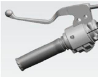
**Maneta de embrague:** Al arrancar el motor o cambiar de marcha, activar esta palanca para conectar o desconectar el embrague.
