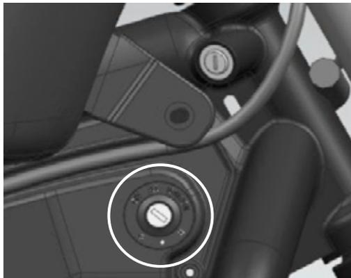
La cerradura de contacto controla el encendido el sistema de iluminación y tiene 2 posiciones: en la primera se enciende el alumbrado y en la segunda es posible el arranque.
